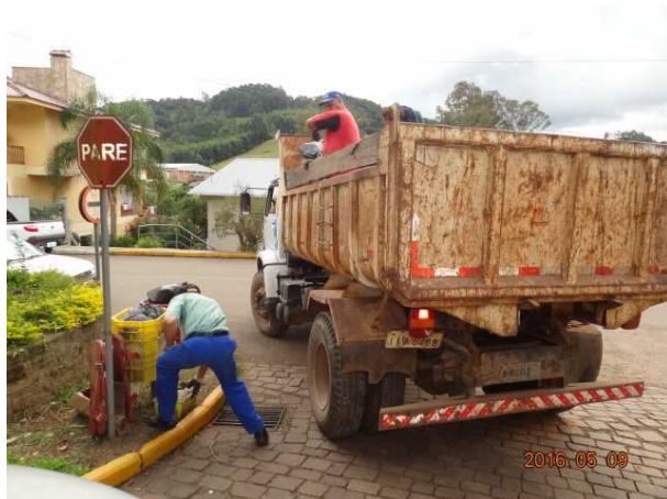
Figura 79: Veículo com carroceria basculante, realizando a coleta convencional.
